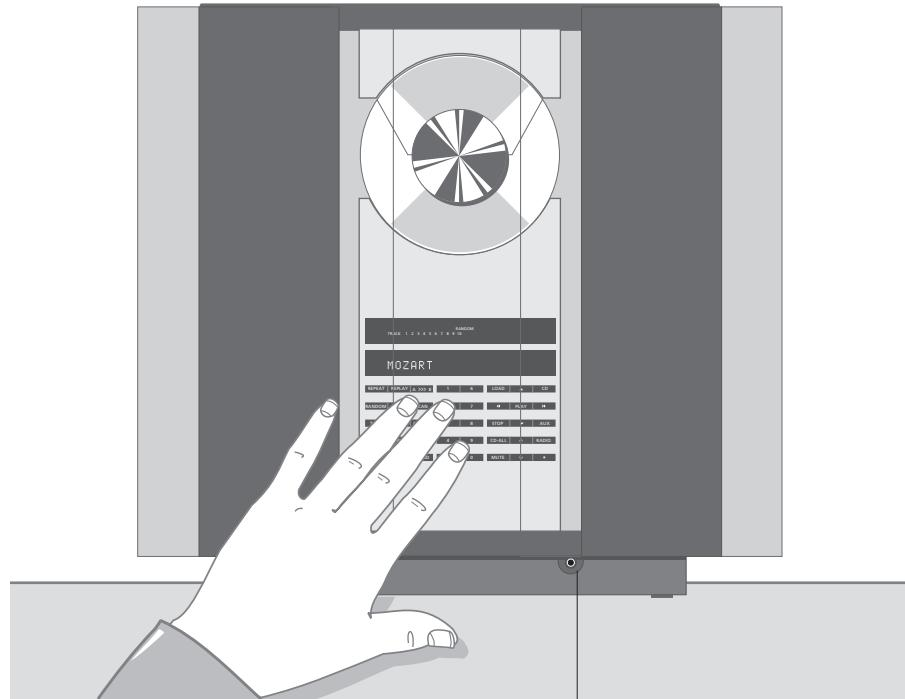
При открытых дверцах Вы имеете доступ к локальной панели управления, обеспечивающей управление всеми функциями проигрывателя компакт-дисков и радиоприемника.
