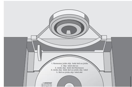
Нажмите кнопку LOAD, расположенную в правой части панели управления, и фиксатор, удерживающий лоток для установки CD, поднимется.
